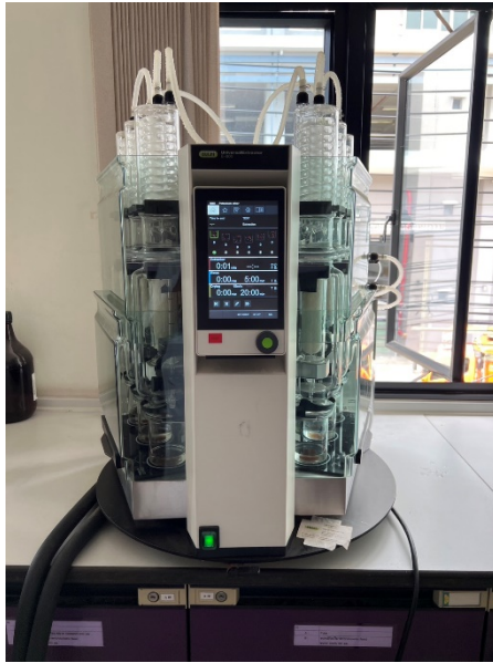
รูปที่ 8 เครื่องวัดปริมาณไขมันในอาหาร
