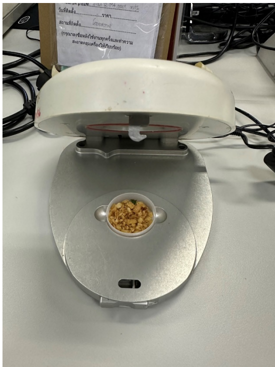
รูปที่ 7 เครื่องวัดค่า a_w และเครื่องวัดความชื้น
